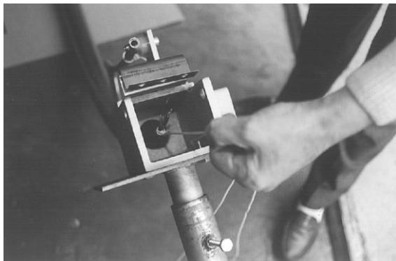
Estrarre il cavo di alimentazione dell'attuatore per tutta la sua lunghezza utile ed infilarlo, attraverso il foro sul lato del basamento, nella scatola destinata ad ospitare il blocco morsetti appositamente preparato.
