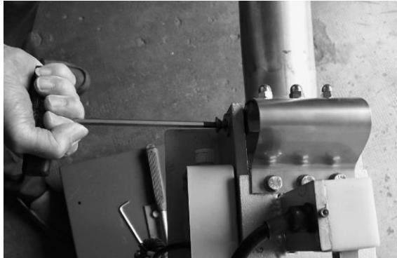
Die Teflon-Führungen werden mit beiden Händen gehalten und dann beide Kondensatorseiten ineinander geführt. Die Kondensatorplatten dabei bitte nicht verbiegen!
