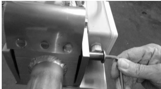
Posizionare l'attuatore nel supporto isolante, inserire il bullone nell'apposito foro del supporto fissando l'occhiello-perno del pistone dell'attuatore, avvitare il dado inox autobloccante fino ad appoggiarlo al supporto isolato **SENZA STRINGERE.**
