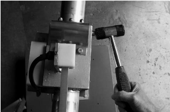
Inserire completamente il perno aiutandosi con un martello in plastica o in gomma. Non forzare mai il perno nell'introduzione: guidare il suo inserimento con piccoli spostamenti del semi-loop se necessario
