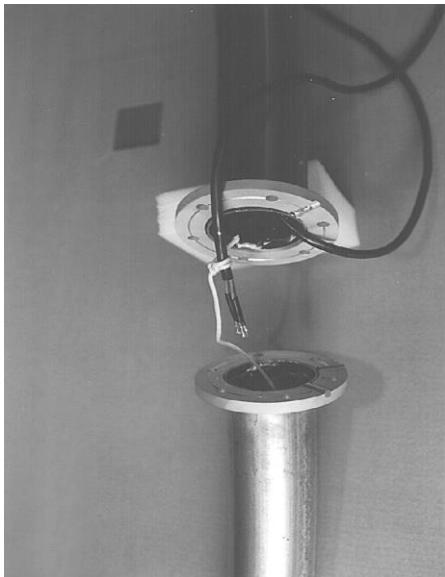
Im Prinzip werden anschließend die beiden anderen Loop-Viertel genau so miteinander verbunden. Bevor sie aber verbunden werden können, muss das Motorkabel durch beide Viertelrohre geführt werden. Das geht leicht mit der inneren Schnur.
