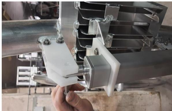
Inserire a questo punto il bullone-perno nell'apposito foro nel supporto isolante fissando nel contempo l'occhiello-perno del pistone dell'attuatore, avvitare il dado inox autobloccante fino ad appoggiarlo al supporto isolato (**senza stringere**).
