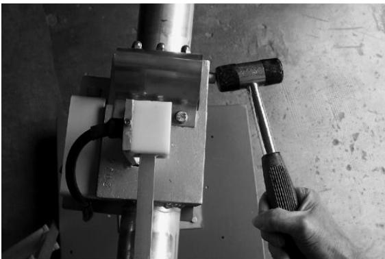
Mit einem Plastikhammer treiben Sie den Stahlbolzen durch Ösen und Gleitlager bis zum Anschlag. Wenden Sie nicht raue Gewalt an! Falls nötig, bewegen Sie eine Loop-Seite während Sie den Bolzen einfügen, bis er perfekt sitzt.
