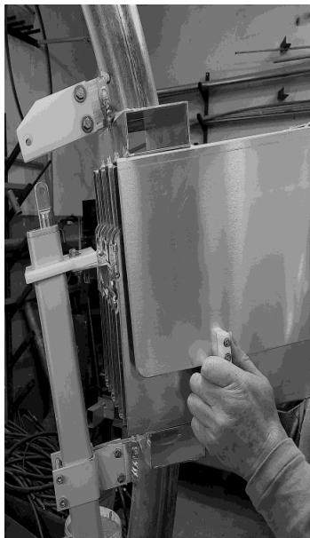
Ist der Kondensator ganz geschlossen, reicht die Öse des Motors in den Isolator. Im Bild wird klar, wie er befestigt wird.
