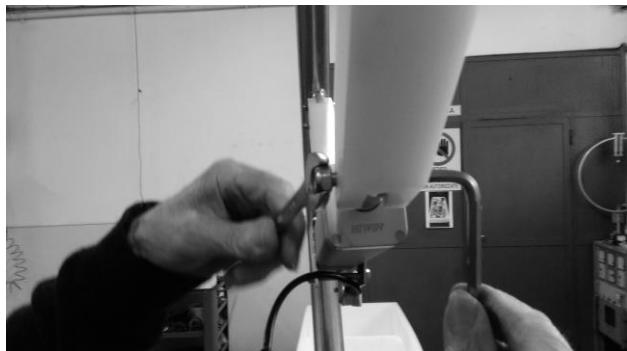
Passare ora al fissaggio della lamina di congiunzione del semi-loop. Prima del montaggio dei bulloni, stendere accuratamente la pasta antiossido (fornita) tra la lamina ed il supporto.
