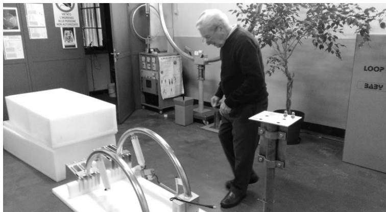
Posizionare il semi-loop con l'attuatore sulla staffa di supporto e fissarlo con i bulloni.
