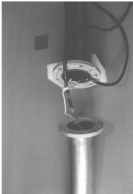
Procedere in modo analogo per il montaggio dell'altra coppia di archi che formerà il semi-loop sul quale è già fissato l'attuatore. Prima di unire i due archi, tuttavia, è necessario far passare il cavo di alimentazione del motore del pistone servendosi per l'operazione del cordino già inserito.
