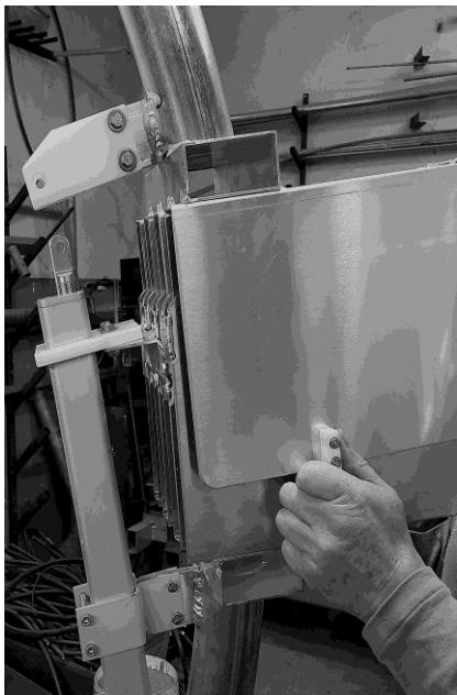
La chiusura del condensatore favorirà l'avvicinamento del perno-pistone al supporto isolante fissato al semi-loop, come mostra la foto di fianco
