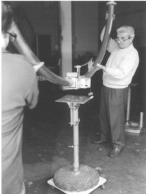
Setzen Sie die Loop auf die Mastklemme wie im Foto gezeigt. Befestigen Sie die Loop darauf mit den zugehörigen Schrauben.
